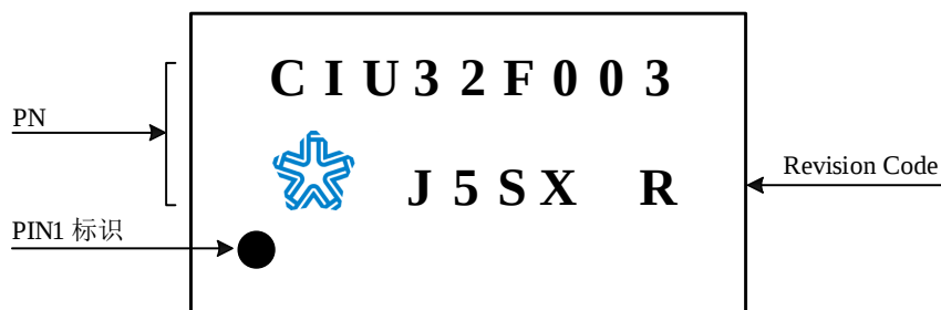
图 5-8 SOP8 封装丝印信息说明
